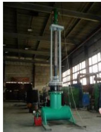
Устройство холодной врезки «БУРЯ-Э500», «БУРЯ-Э500А» конструкции Р.С. Янышева предназначено для сверления отверстий в трубопроводах, находящихся под давлением. Преимуществами устройств холодной врезки «БУРЯ-Э300», «БУРЯ-Э500», «БУРЯ-Э300А», «БУРЯ-Э500А» защищённых патентами РФ являются:
