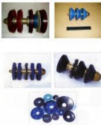
Очистные устройства (ОУ) типа "ОУ-П" предназначены для очистки поверхностей промысловых трубопроводов от осфальтосмольных и парафиновых отложений и для вытеснения продуктов и инородных предметов из внутренней полости трубопровода диаметром 114 - 273 мм. Предлагаемые очистные устройства отличаются простотой и надежностью конструкции, градусные отводы с радиусом поворота до 1,5 Dn (Dn - номинальный диаметр трубы).
