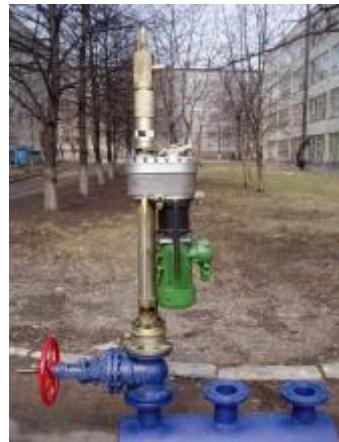
Устройство холодной врезки «БУРЯ-Э100А», «БУРЯ-Э200А» конструкции Р.С. Янышева предназначено для сверления отверстий в трубопроводах, находящихся под давлением. Преимуществами устройств холодной врезки «БУРЯ-Э100А», «БУРЯ-Э200А» защищённых патентами РФ являются:
