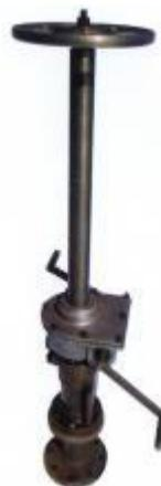
Устройство холодной врезки “БУРЯ-Р150Р” с ручным приводом конструкции Янышева Р.С. предназначено для врезки отводов в действующий трубопровод, находящийся под давлением. Преимуществами устройства холодной врезки “БУРЯ-Р150Р”, защищённого патентами РФ являются:
