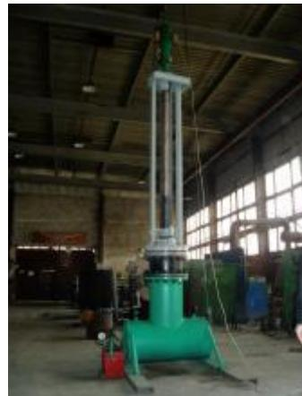
Устройство холодной врезки «БУРЯЭ-300», «БУРЯЭ-300А» конструкции Р.С. Янышева предназначено для сверления отверстий в трубопроводах, находящихся под давлением. Преимуществами устройств холодной врезки “БУРЯ-Э300”, “БУРЯ-Э300А” защищённых патентами РФ являются:
