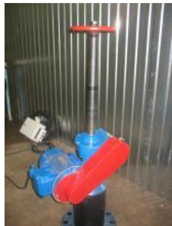
Устройство холодной врезки «БУРЯ-Э200Р» конструкции Р. Янышева предназначено для сверления отверстий в трубопроводах, находящихся под давлением.
