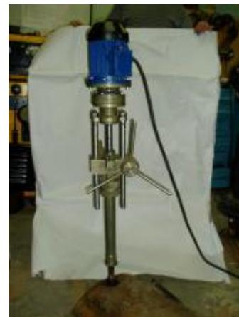
Устройство «холодной» врезки «БУРЯ-М», «БУРЯ-М1» конструкции Р.С. Янышева предназначено для сверления отверстий в трубопроводах, находящихся под давлением. Преимуществами устройств холодной врезки «БУРЯ-М», «БУРЯ-М1» защищённых патентами РФ являются:
