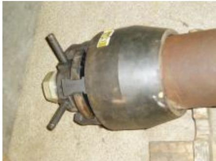
Устройства “Затвор” конструкции Янышева Р.С. предназначены для временной заглушки открытых концов труб, плетей, а также "окатушенных" задвижек, отводов и тройников при их гидроиспытаниях.
