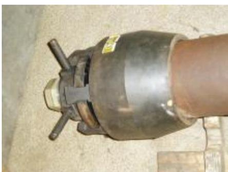
Устройства "Затвор" конструкции Янышева Р.С. предназначены для временной заглушки открытых концов труб, плетей, а также "окатушенных" задвижек, отводов и тройников при их гидроиспытаниях. Использование предлагаемых устройств является альтернативой таким непроизводительным операциям как: приварка заглушек, срезание их после гидроиспытаний, повторная подготовки кромки под сварку. При использовании устройств увеличивается производительность работ, снижается их трудоёмкость.
